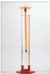
↑ Introduzir o termômetro na proveta, tendo o cuidado de manter a coluna de mercúrio totalmente imersa. Uma vez estabilizada a temperatura, manter o termômetro imerso no etanol por dois (2) minutos, efetuar a leitura e anotar.
