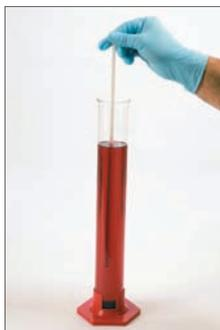
↑ Introduzir o termômetro, tendo o cuidado de manter a coluna de mercúrio totalmente imersa. Manter o termômetro imerso no produto por dois (2) minutos, efetuar a leitura e anotar.
