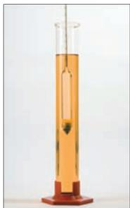
↑ Encher a proveta de 1 litro. Mergulhar o densímetro limpo e seco na proveta, de modo que o densímetro flutue livremente sem tocar o fundo ou as paredes da proveta.
