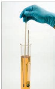
↑ Introduzir o termômetro na amostra, tendo o cuidado de manter a coluna de mercúrio totalmente imersa. Uma vez estabilizada a temperatura, mantendo o termômetro imerso na gasolina, efetuar a leitura e anotar.
