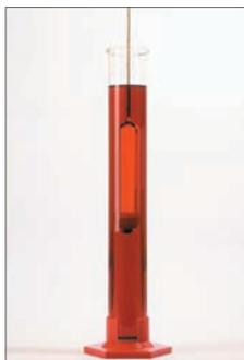
↑ Encher a proveta de 1 litro com a amostra. Mergulhar o densímetro limpo e seco no produto, de modo que flutue livremente sem tocar o fundo ou as paredes da proveta.
