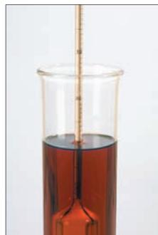
↑ Fazer a leitura do densímetro e do termômetro, no plano da superfície do líquido. Em seguida, consultar a Tabela de Conversão das Densidades do Diesel (que converte a densidade para 20°C).
