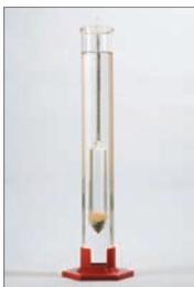
↑ Encher a proveta de 1 litro com a amostra. Mergulhar o densímetro limpo e seco, de modo que flutue livremente, sem tocar o fundo ou as paredes da proveta.
